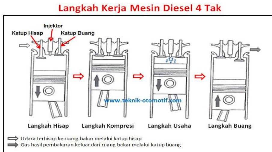
Gambar 2.2 Langkah Kerja Mesin Diesel 4 Tak
