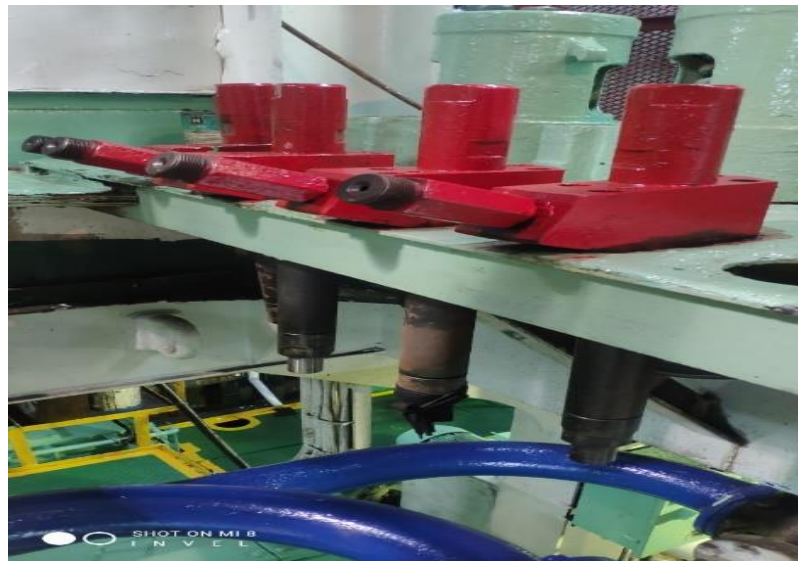
Gambar 16 Injector Cadangan Setelah Dites Ulang di Kapal KM. Tanto Abadi
