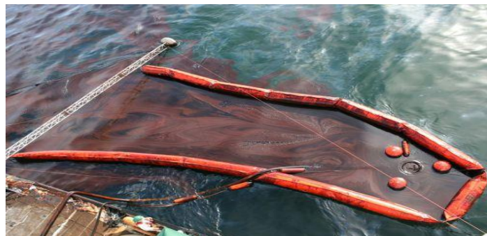
Gambar 2 : Pencegahan Penyebaran Minyak dengan Oil Boom (Sumber: greenerideal.com)
