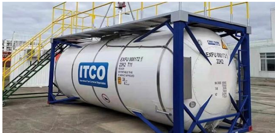
Gambar 5 Tank Container Sumber : data penulis, 2021
