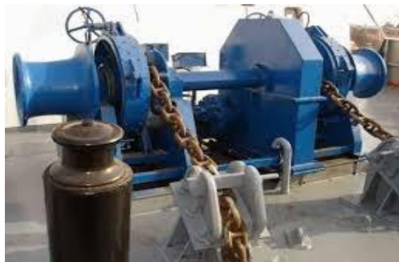
(Sumber : Stone Rd (2008). Anchor Windlasses ) Gambar 2.6 Mesin Jangkar
