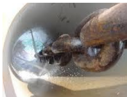
Gambar 2.3 Tabung Jangkar Pada Kapal
