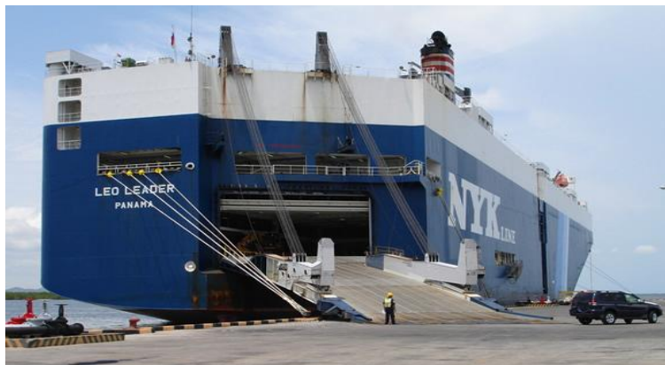
Gambar 6 Stern ramp door . Sumber:
