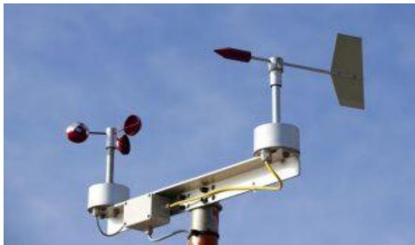
**Gambar 2.6** Alat Pengukur Angin Anemomter Dan Wind Vane
