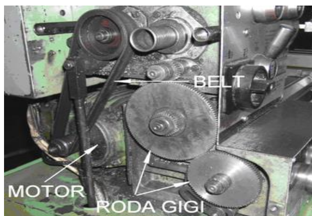
Gambar 24. Perpindahan Putaran Dari Motor Melalui Belt Dan Roda Gigi (Rachmad, Soeprapto. 2008. Teknik Pemeliharaan Mekanik Industri)
