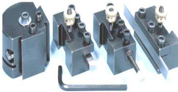
Gambar 18. Pemegang Pahat Dapat disetel (Adjustable Tool Post) (Rachmad, Soeprapto. 2008. Teknik Pemeliharaan Mekanik Industri)
