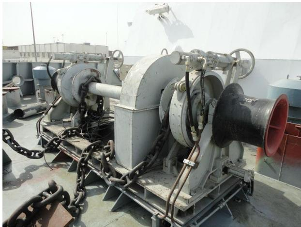
Gambar 2.11 Konstruksi pendukung mesin jangkar
