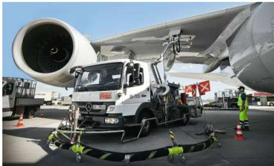
**Gambar 14. Pengisian Avtur Ke Pesawat Dengan Tipe Mesin Turbin**
