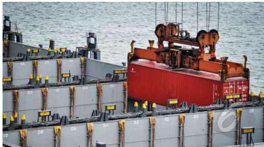
**Gambar 9. Kegiatan *Shifting Muatan Pada Kapal Kontainer***
