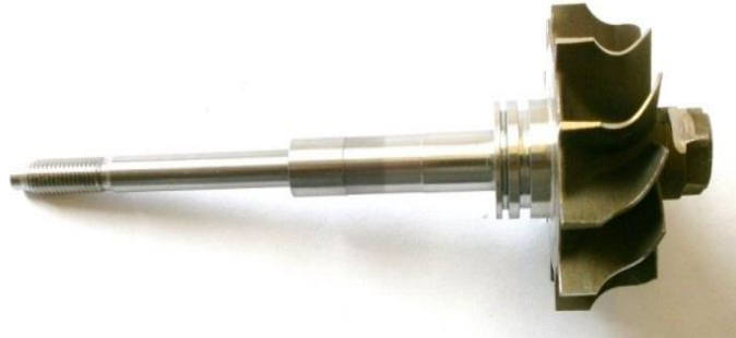
Gambar 2 Turbin Pada Turbocharger ( turborebuild.co.uk 22-10-2018)
