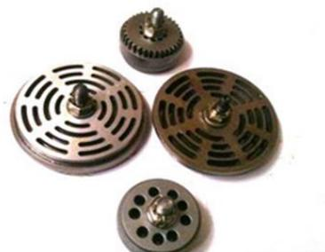
Gambar 9 Katup kompresor (*Compressor Valve*)
