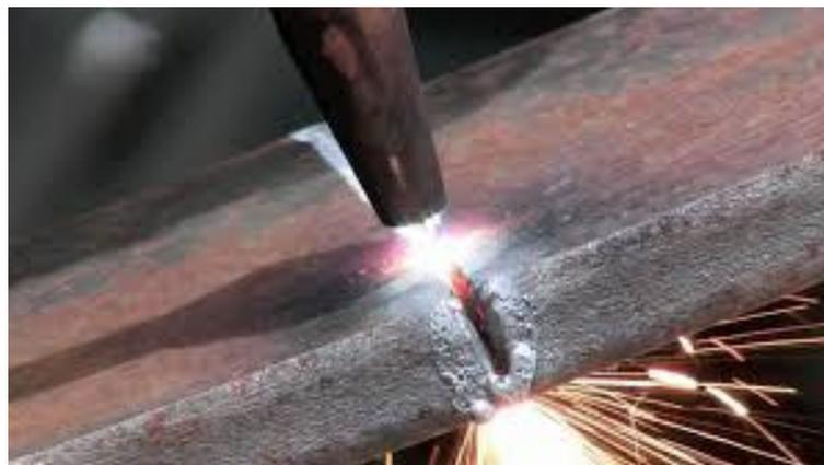
Gambar 12 Pemotongan Logam dengan brander potong
