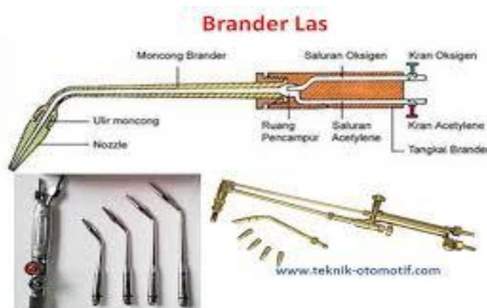
Gambar 14. Bagian Brander potong las *Oxy-acetylene*
