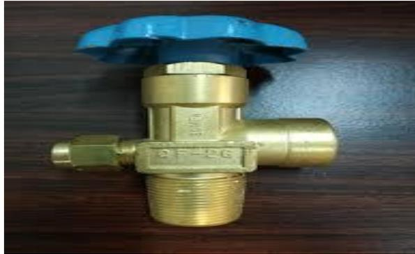
Gambar 3 Katup Silinder oksigen
