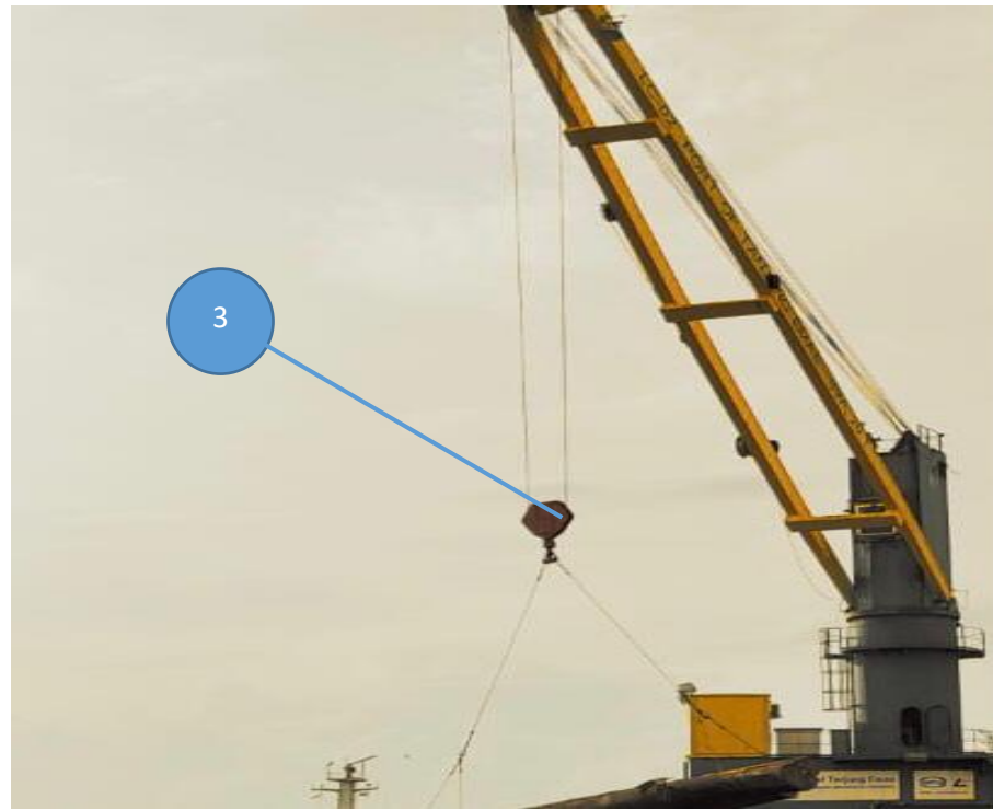
Gambar 2.4 Pengkait crane Sumber: PT. Bahtera Setia Semarang
