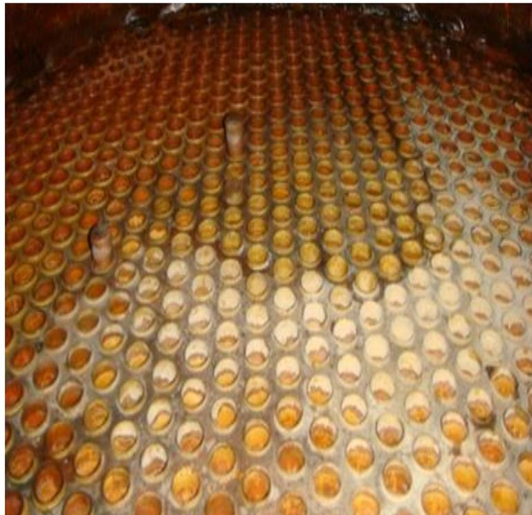
Gambar 2.2 Permukaan Evaporator
