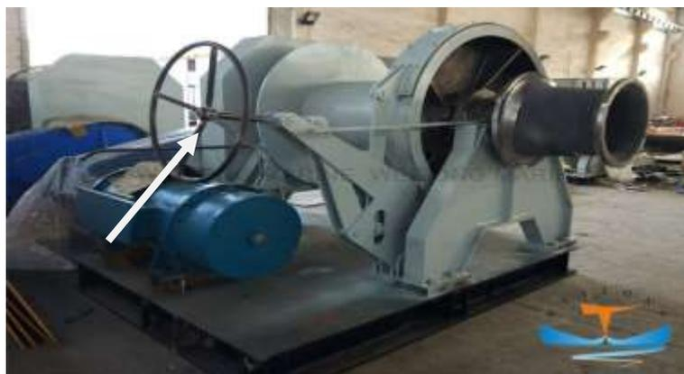
Gambar 16: Tuas Rem pada *Windlass*
