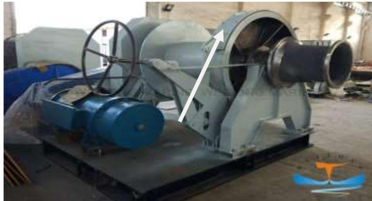
Gambar 17: Sepatu Rem pada *Windlass*
