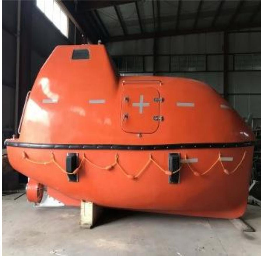
Gambar 7. Gambar sekoci terbuat dari aluminium
