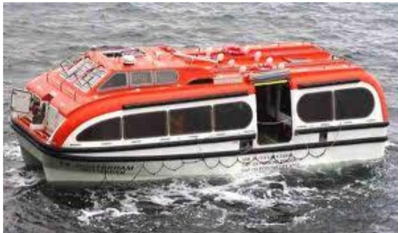
Gambar 6. Gambar sekoci terbuat dari baja
