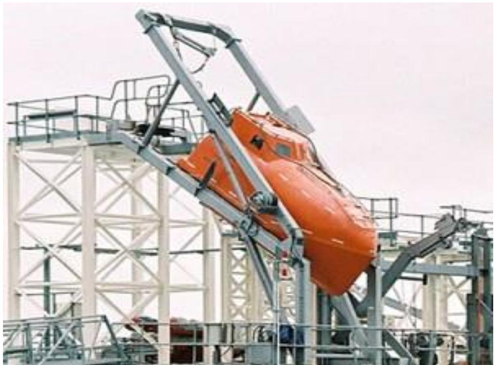
Gambar 19. Gambar sistem gravitasi
