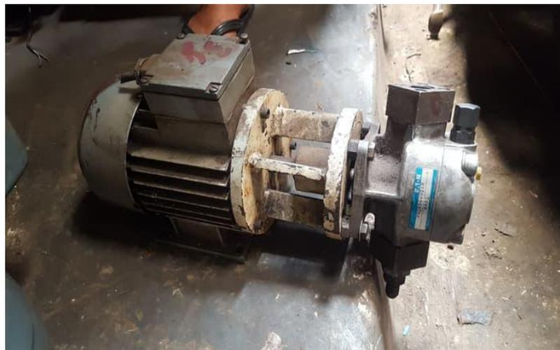
Gambar 5 pompa hidrolik
