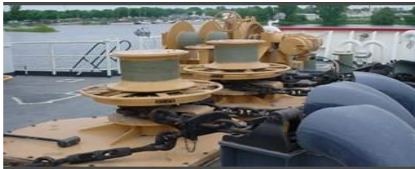
Gambar 5. Windlass berposisi vertikal (Sumber : Stone Rd (2008))
