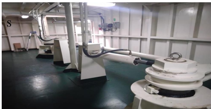
Gambar 1 : Mesin kemudi KM. Sabuk Nusantara 77 (KM. SABUK NUSANTARA 77, 2019)
