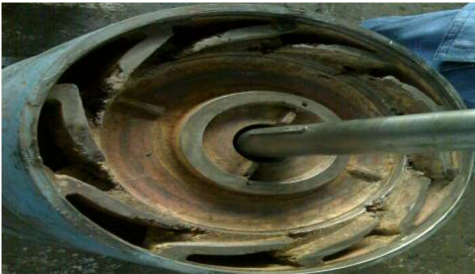
Gambar 8 Impeller setengah terbuka KT ANOMAN V
