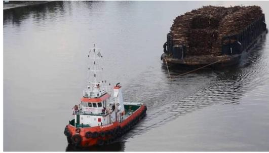
Gambar 5 *Lighter Carrier*(Kapal Pengangkut Tongkang)
