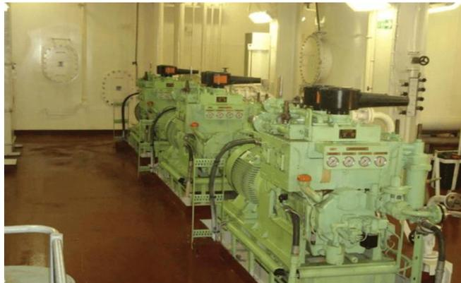
Gambar.12: Kompresor udara
