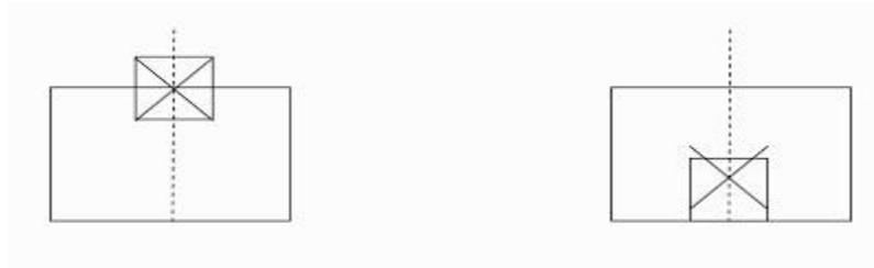
Gambar 1. Muatan diletakkan diatas. Gambar 2. Muatan diletakkan dibawah Pembagian muatan secara longitudinal ( membujur )
