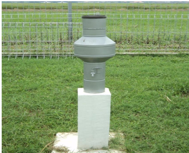
Gambar 6 Penakar Hujan Tipe OBS (Observatorium) Sumber : BMKG
