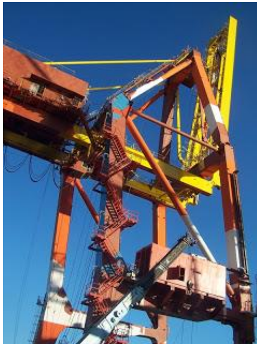
Gambar 2.3 Alat bongkar muat kapal jenis Container Crane
