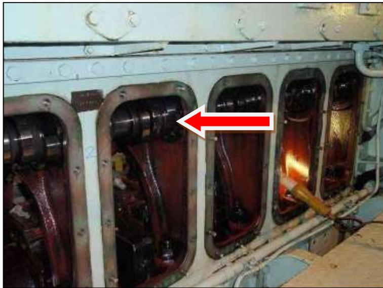
Gambar 2.6 Camshaft SV .MINERVA 88
