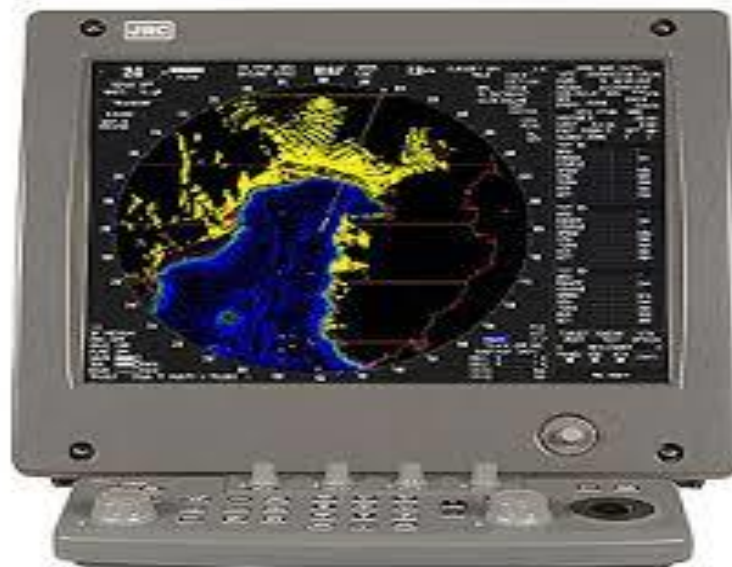
Gambar.2 RADAR yang dilengkapi ARPA ( Automatic Radar Plotting Aid ) Sumber MT.Kahayan
