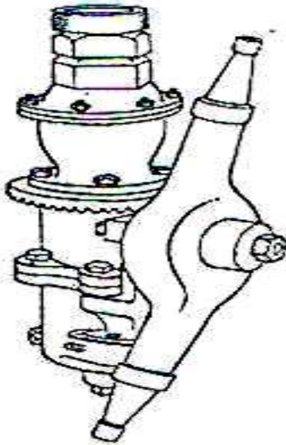
Gambar 1 : Alat pembersih tangki “ Butterworth “
