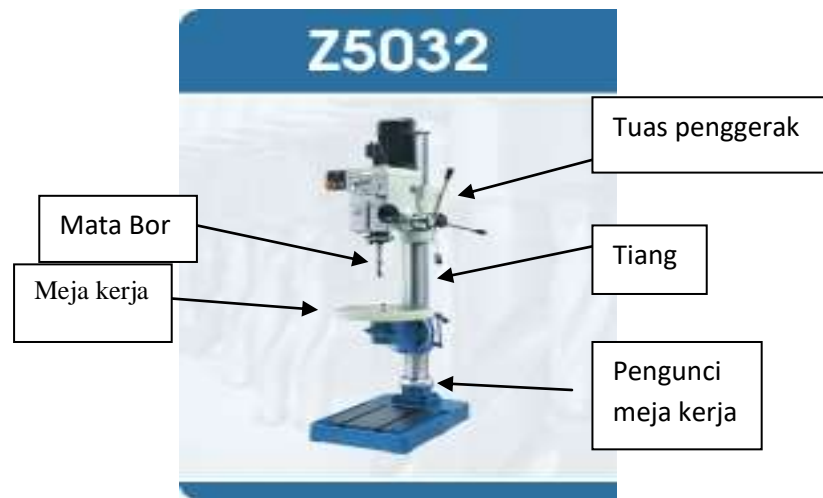
Gambar 1.4 Mesin bor Tegak
