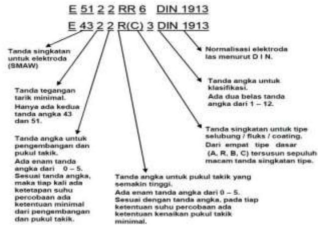
Gambar 4. Kode Elektroda
