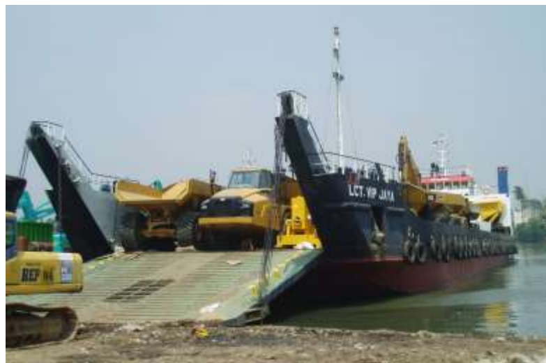
Gambar 13 Ramp door terbuka
