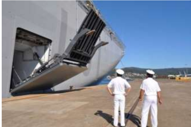
Gambar 4 Side ramp door
