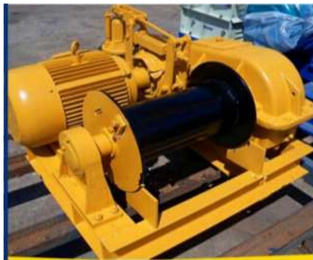
Gambar 12 Winch Atau Mooring
