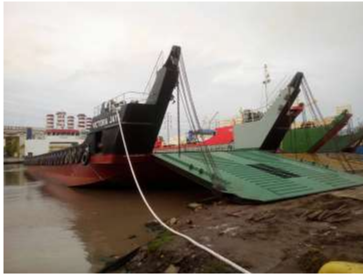
Gambar 8 Pintu Rampa Kapal Victoria Jaya Sumber: PT. Profab Indonesia 2015
