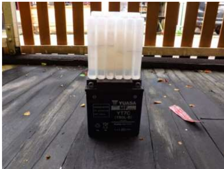
Gambar 7. Cairan Elektrolit untuk battery
