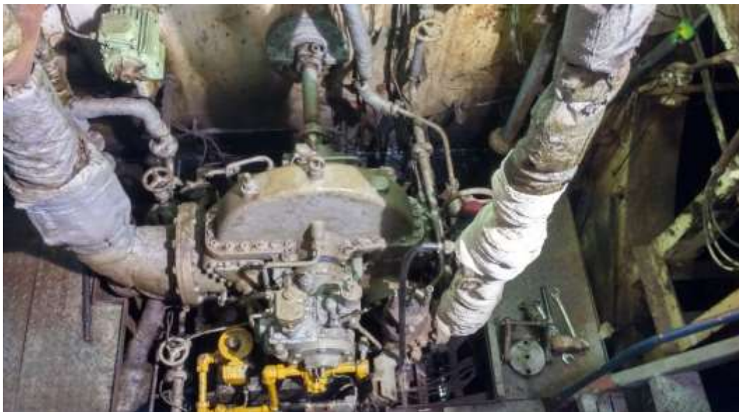
Gambar 2.1 Turbin Uap penggerak pompa cargo (MT.Pelita P1023)
