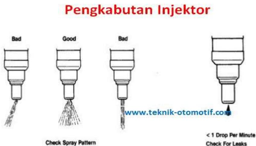
**Gambar 6** Bentuk – bentuk Pengkabutan Injektor.
