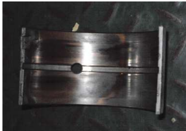
Gambar 9 Keausan Karena Minyak Lumas Bercampur Air (Dokumentasi: 19 September 2019)
