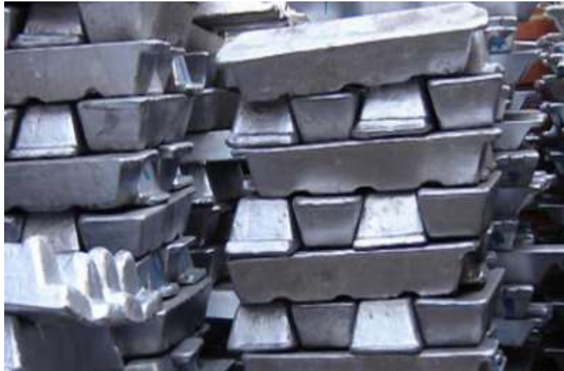
Gambar 3 alumunium mentah (Gambar bahan Elemen bantalan)
