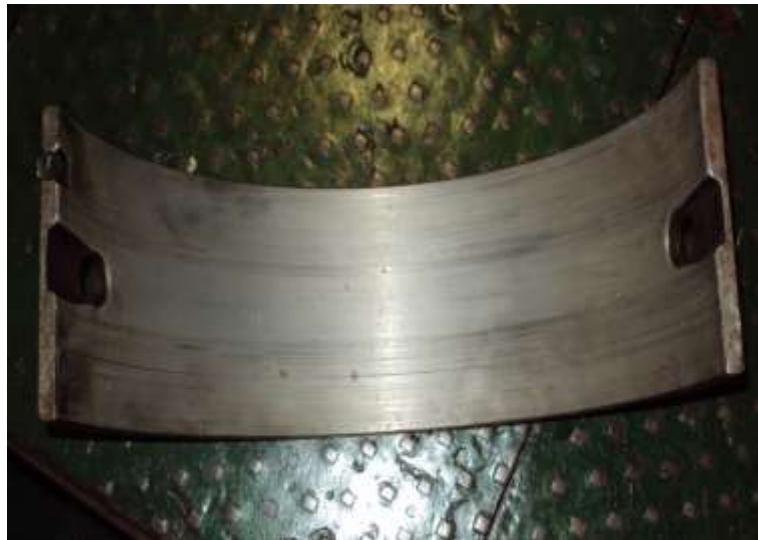
Gambar 6 bantalan utama mesin induk. (Dokumentasi: 19 September 2019)
