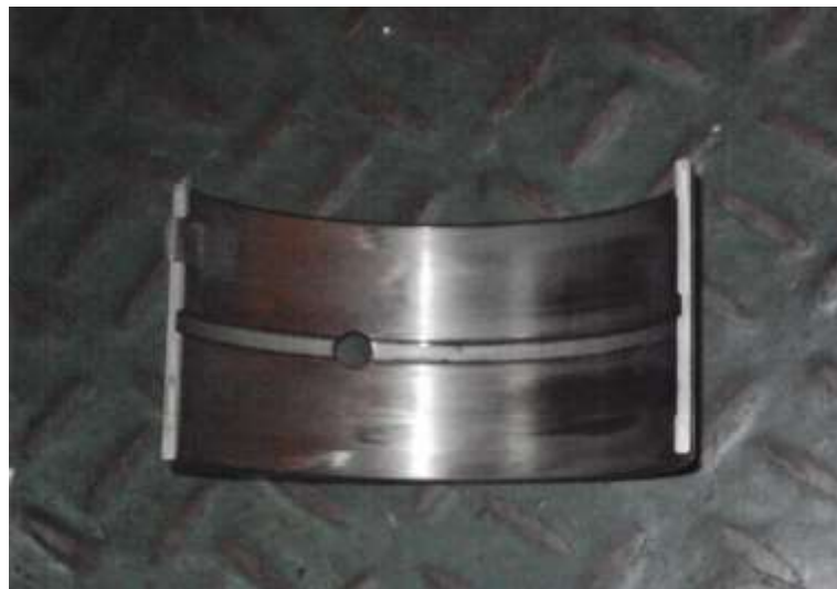
Gambar 7 Keausan Karena Temperatur yang Tinggi (Dokumentasi: 19 September 2019)
