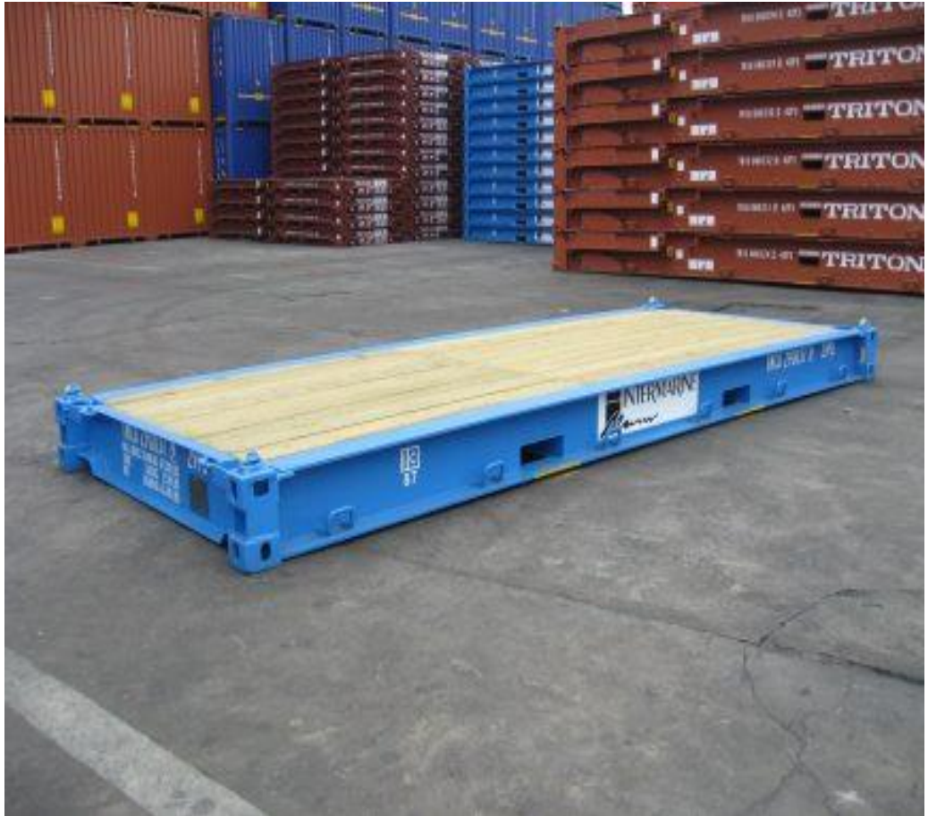
Gambar 2.18 : Kontainer Jenis Platforms Container .
