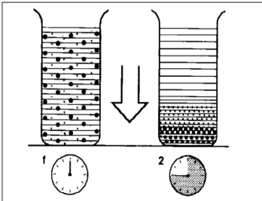
**Gambar 1.** Prinsip Dasar Pengendapan Zat Cair.
