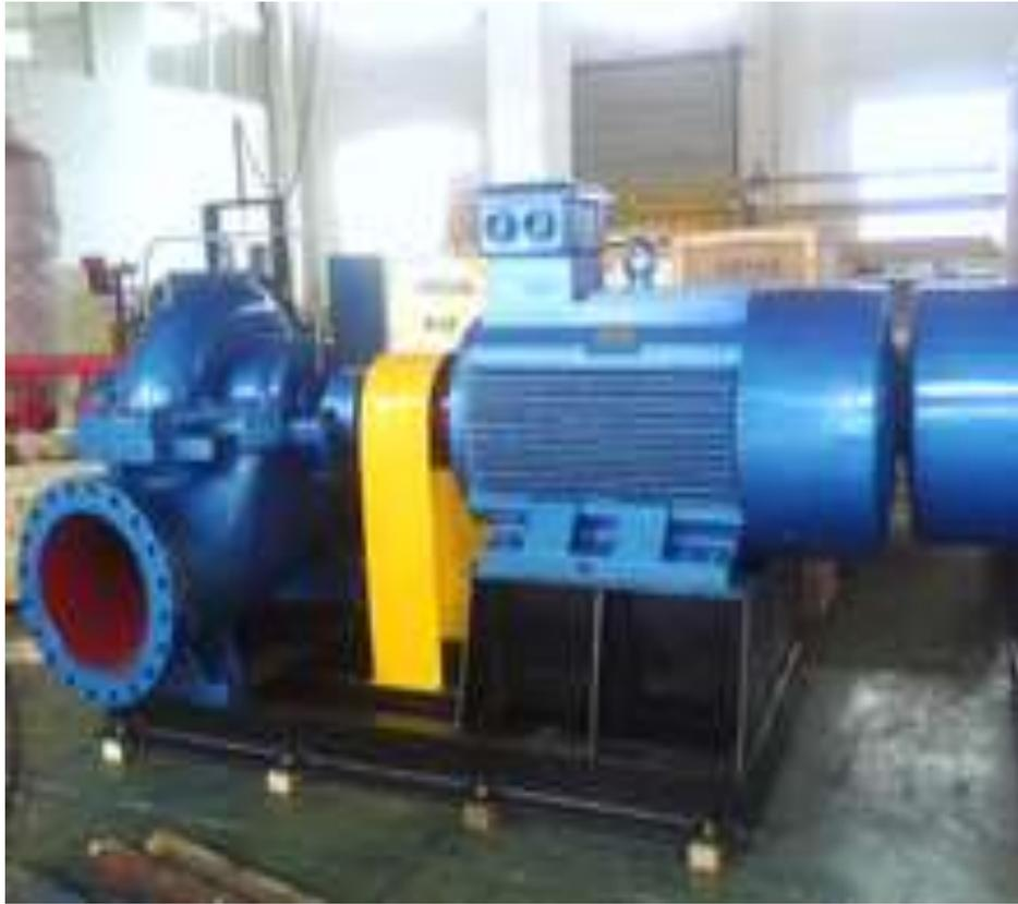
Gambar 7. Pompa pendingin air laut
