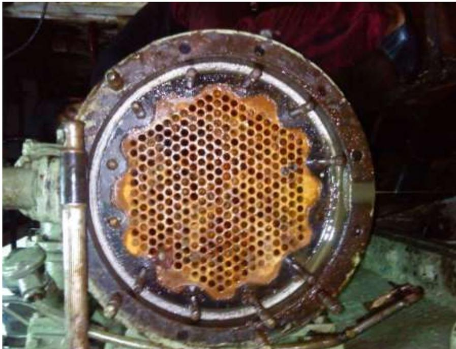
Gambar 3. Bagian Dalam Fw cooler
