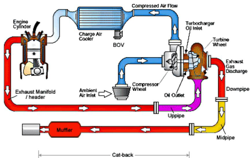
Gambar 2.6. Langkah Kerja Turbo Charger
