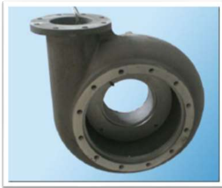
Gambar 1. Casing Pompa Centrifugal Sumber: MT. Bintang Mas – HSB I, Pompa Ballast
