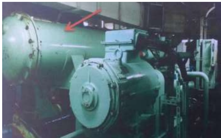
Gambar 3. Kondensor (Sumber: KM. SIMORE)
