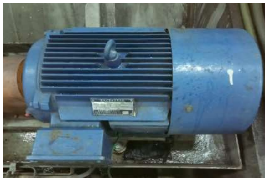
Gambar 7. Motor listrik (Sumber: KM. SIMORE)
