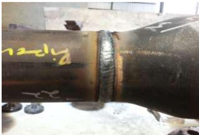
Gambar 2 sambungan las pipa
