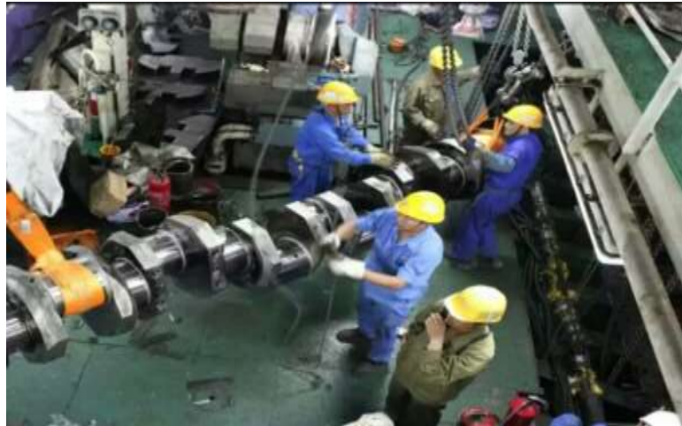
Gambar 2.9 pemasangan crankshaft (Sumber : MV.SUMBER CAHAYA 88)
