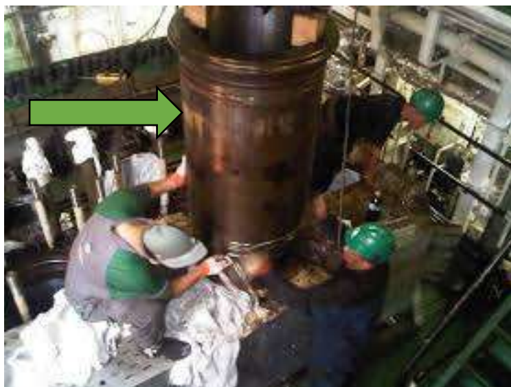
Gambar 4.4 Cara melepas silinder liner
