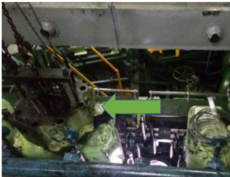
Gambar 4.2. Cara mengangkat cylinder head
