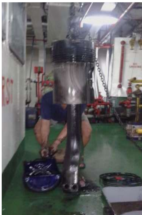
Gambar 4.3 Cara mengangkat piston
