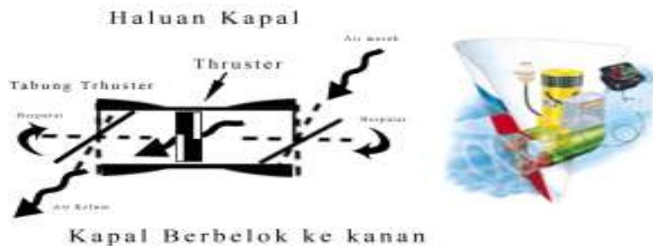
Gambar 2.1 : Arah aliran air dalam *tunnel*
