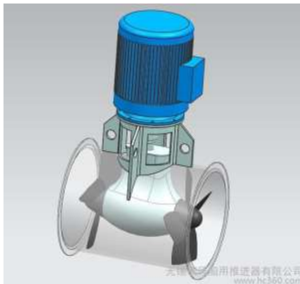
Gambar 2.7 : Bow thruster (Sumber : Gerrynaal.2010, 12/12. Teknologi Perkapalan)
