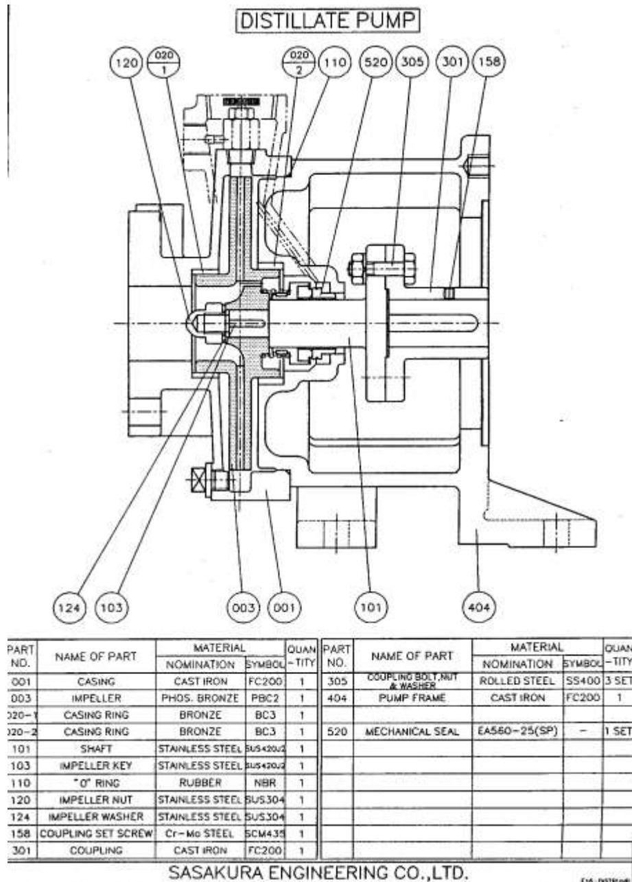
Gambar 7 Bagian bagian pompa *distillate*
