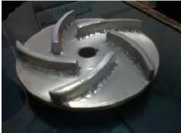
Gambar 7 Impeller setengh terbuka
