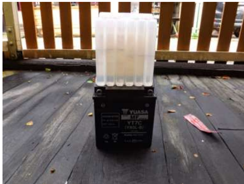
Gambar 7. Cairan Elektrolit untuk baterai Sumber. Budi Arief Rahman, 2014
