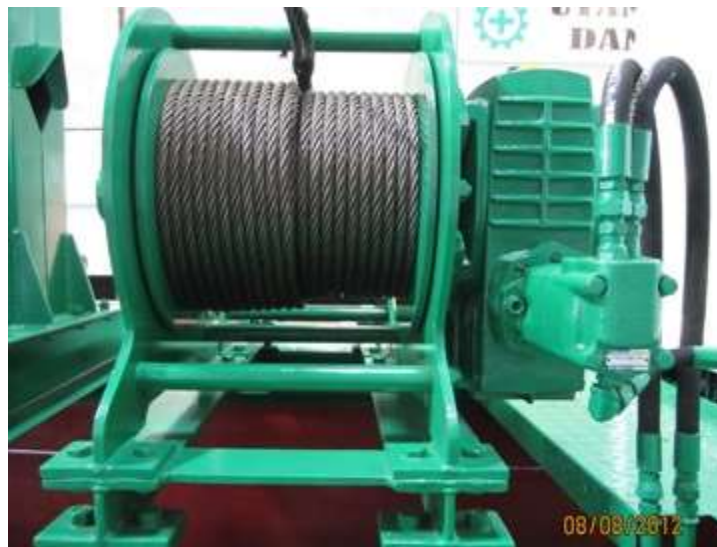
Gambar 1 Whinc dengan sistem penggerak hidrolik Sumber: http://banterdredger.com/Dredge_Equipment.html [24 Maret 2018]
