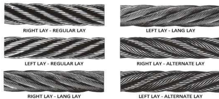
Gambar 4 Bentuk Wire Rope Pada Ramp Door
